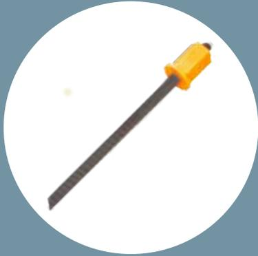
Tiene 12 cm de rosca en un extremo y corte a 45° en el otro extremo, cuenta con una tuerca adherida con resina a la rosca del ancla y esta reforzada con fibra de vidrio.
